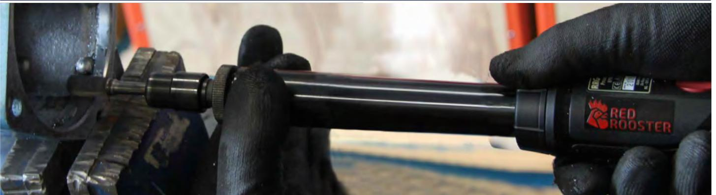
Les meuleuses droites RED ROOSTER sont extrêmement appropriées pour l'ébavurage, la finition des joints soudés et les applications pour meuleuses droites en général. La gamme de meuleuses droites RRG est développée pour une productivité de pointe. L'arbre peut être verrouillé par bouton-poussoir pour changer les bavures sans outils.
