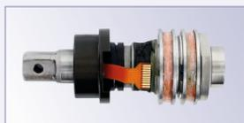
Les jauges de contrainte fixées sur l'axe d'entraînement mesurent le couple de torsion à chaque impulsion, à proximité immédiate de la douille. Le signal électrique est transmis par induction au travers du carter. Ce principe rend le capteur YOKOTA très fiable, précis et inusable. Un outil idéal pour les opérations d'assemblage en chaîne de production.
