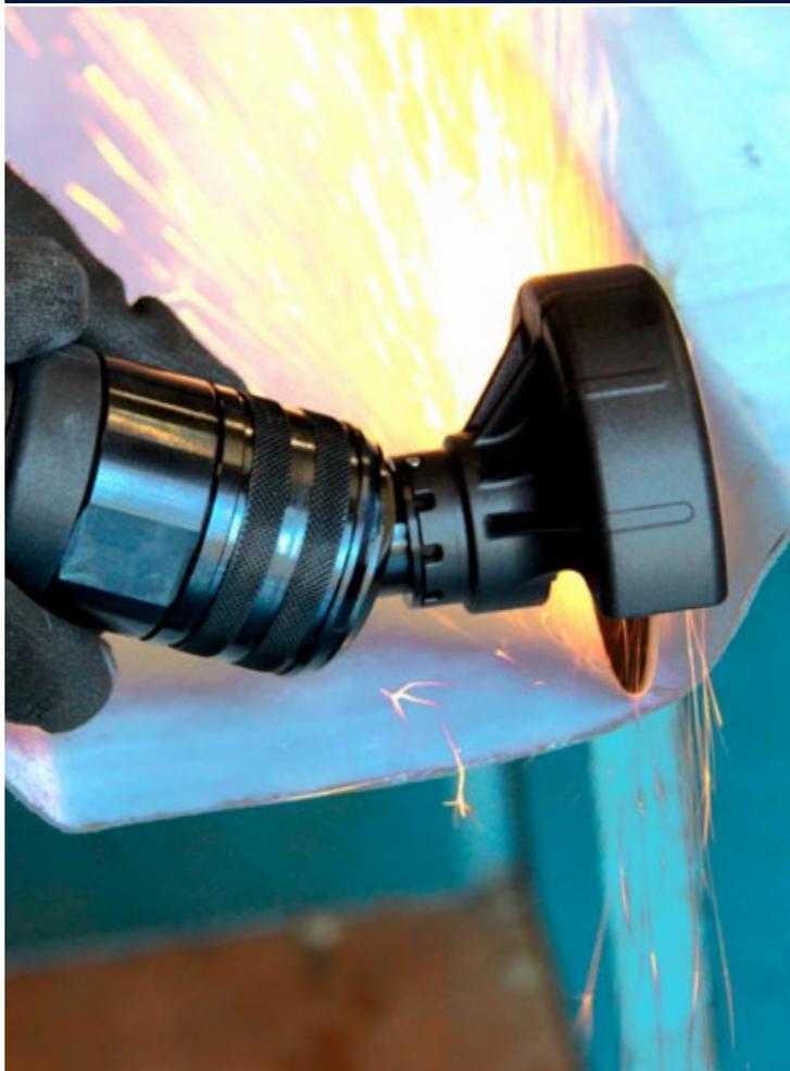
Dieser Red Rooster Trennschleifer wird mit 75 mm Trennscheiben verwendet. Aufgrund des flexiblen Schwenkkopfes erreichen Sie einfach schwer zugängliche Stellen; dies maximiert die ergonomischen Eigenschaften und ermöglicht Ihnen höchst präzises Schleifen. Dieses Werkzeug hat einen sehr starken Luftmotor von 600 Watt. Bestens geeignet zum exakten Schneiden von beispielsweise Stahlblech, Karosserien und Auspuffrohren.
