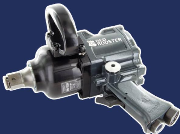
Cette clé à chocs de Red Rooster présente un superbe rapport poids/puissance. Le RRI-1031 est développé pour les applications d'assemblage et de démontage. Le mécanisme d'impact à 3 mâchoires donne des niveaux d'énergie élevés par impact. L'outil est adapté à un usage industriel. Le poids léger de l'outil assure une manipulation parfaite. Couple de déserrage : 3.350 Nm.
