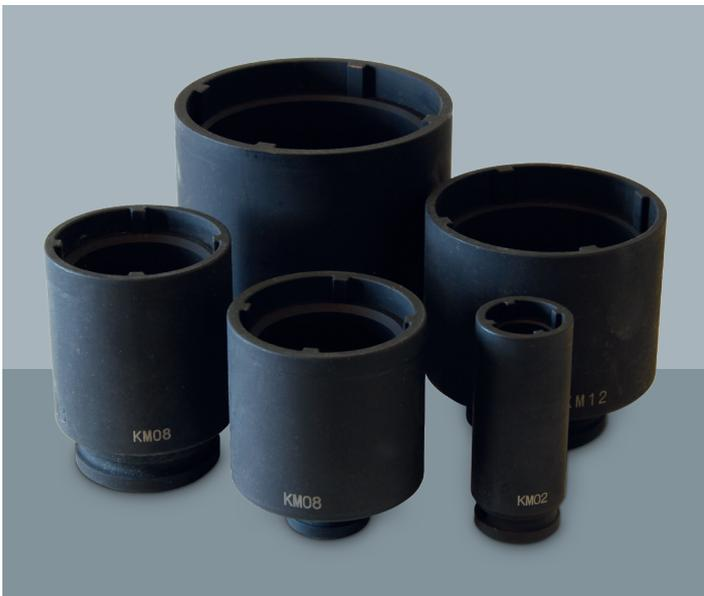
Ein komplettes Sortiment an ACTION-Kraftsteckschlüssel-Einssätze für Wellenmutter ist jetzt ab Lager verfügbar. Die Größe 1/2" mit Vierkantantrieb deckt die Muttergrößen KM02 bis KM08 ab. Vierkantantrieb 3/4" für Muttern der Größen KM07 bis KM13. Vierkantantrieb Größe 1" deckt die Größen KM14 bis KM18 ab.
