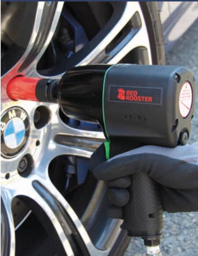
Les clés à chocs RED ROOSTER à limiteur de couple travaille à pleine puissance pour desserrer tandis qu'au serrage, le couple est limité à 90 Nm. Cette restriction garantit que les boulons de roues ne soient pas TROP serrés. Utilisez toujours une clé dynamométrique pour contrôler le couple!
