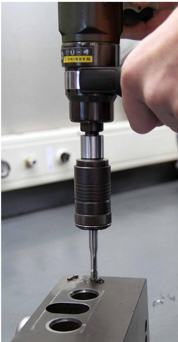
La taraudeuse universelle RED ROOSTER RRI-T330M12 a été développée pour le taraudage manuel. Le sens de rotation et la vitesse se règlent facilement avec le commutateur à bascule. C'est un outil ergonomique qui s'intègre parfaitement dans la main. Sortie d'air silencieuse par la poignée. Grâce au support à changement rapide, différentes tailles de porte-tarauds peuvent être changées rapidement et facilement.
