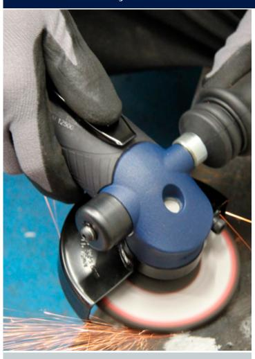
Cette meuleuse d'angle à air comprimé de Yokota est utilisée pour le tronçonnage et la rectification. Une machine industrielle de qualité supérieure. La meuleuse est livrée avec un régulateur intégré qui assure une sécurité maximale et un régime précis, pour un fonctionnement optimal. Le moteur pneumatique a une puissance élevée. L'axe peut être tenu par un bouton poussoir pour un échange aisé des accessoires tels les meules.
