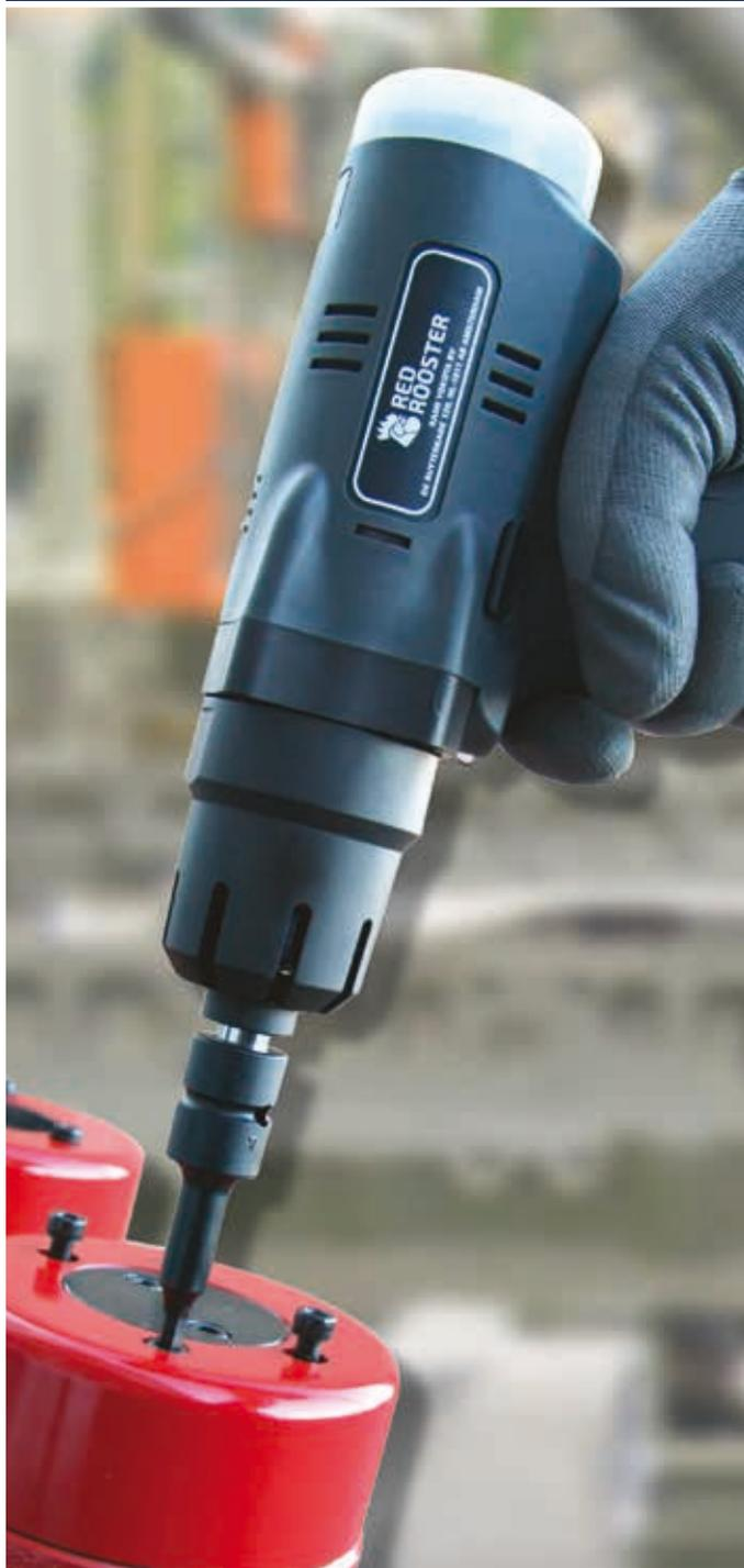
Der RRI-BIM-Serie Akkuabschaltimpulsschrauber hat eine hohe Schraubgeschwindigkeit mit genauem Drehmoment kombiniert. Es entstehen keine Reaktionskräfte während des Schraubvorgangs. Der bürstenlose Motor hat eine lange Lebensdauer, arbeitet ohne Instandhaltung und ist sehr effizient.
