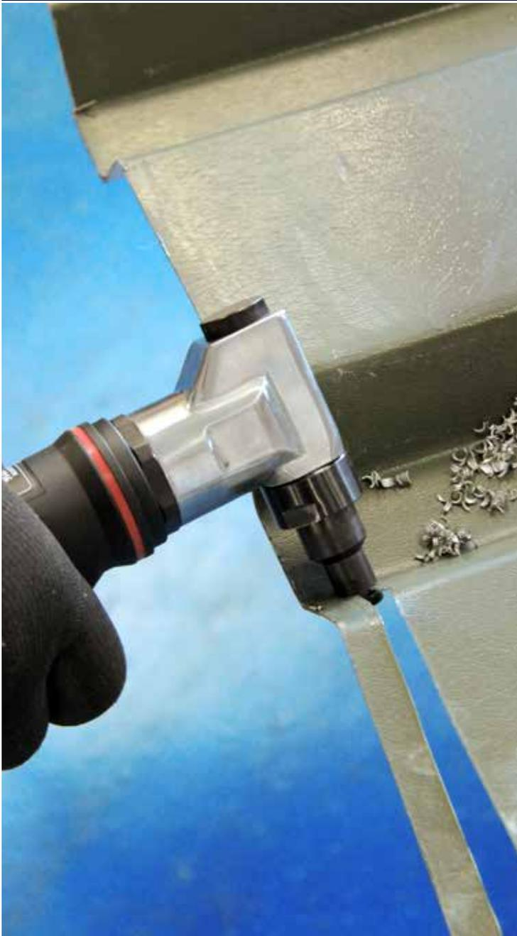
Der Red Rooster RR-8116 Knabber ist schnell und einfach zu manövrieren, um Kreise, Kurven und Ecken in Blech und Karosserie zu schneiden. Ideal auch für wellige beziehungsweise unebene Blecharbeiten. Das geschnittene Blech wird nicht verformt. Der Kopf kann in vier Schritten von neunzig Grad so eingestellt werden, dass er perfekt zum Werkstück passt.
