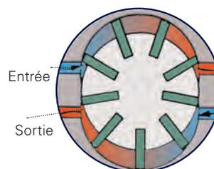
Les visseuses hydrotension à moteur pneumatique à double chambre atteignent rapidement le couple de serrage nécessaire.
