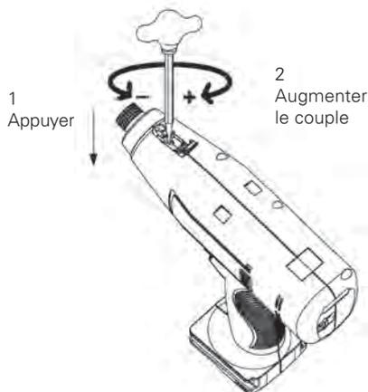
2. Utilisez la clé d'ajustement en l'enfonçant dans l'ouverture prévue à cet effet. Tournez ensuite dans le sens des aiguilles d'une montre pour augmenter le couple.
