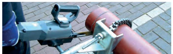
Toujours utiliser l'etau à tube et la chaîne pour la fixation de l'outil!
