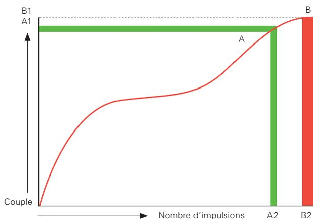
A = zone de coupure des visseuses hydrotension mécaniques.
