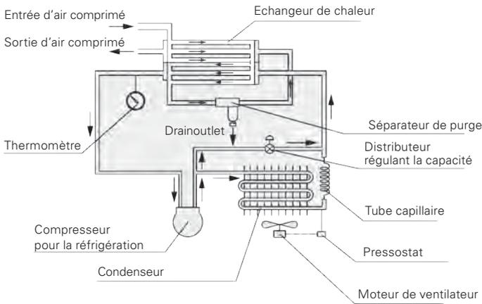
L'air comprimé saturé entre dans l'échangeur air-air puis est prérefroidi par l'air froid se trouvant déjà dans le sécheur. L'air passe ensuite au travers de l'évaporateur, où il sera refroidi jusqu'à atteindre un point de rosée de 3°C. A mesure que l'air se refroidit, l'eau se condense, et ce condensat est retiré lors de la purge automatique. L'air sec repasse ensuite dans l'échangeur air-air où il est réchauffé avant de quitter le sécheur.
