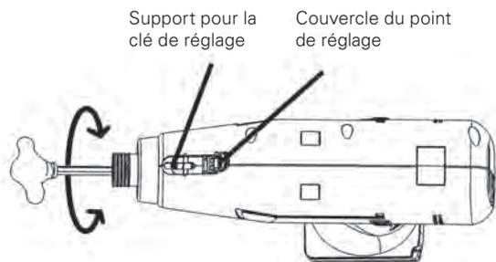
1. Ouvrez le couvercle du point de réglage. Insérez la clé dans le support et tournez jusqu'à ce que l'ouverture devienne visible.
