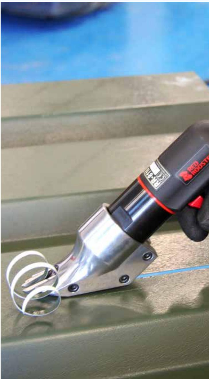
Die Red Rooster RR-8110 Blechschere entfernt einen schmalen Streifen vom zu schneidenden Blech. Ideal zum schnellen Schneiden von Blechen; macht einen engen Schnitt, ohne das Blech zu verformen. Auch für gebogene Bleche wie dünnwandige Rohre geeignet. Der Kopf ist um 360° in jede Einstellung verstellbar.
