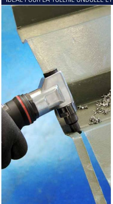
Les grignoteuses Red Rooster RR-8116 sont rapides et faciles à manœuvrer pour couper les cercles, les courbes et les coins dans la tôle et la carrosserie. Idéal également pour la tôlerie ondulée et ronde / convexe. La tôle découpée n'est pas déformée. La tête peut être ajustée en quatre étapes de quatre-vingt-dix degrés pour s'adapter parfaitement à la pièce.
