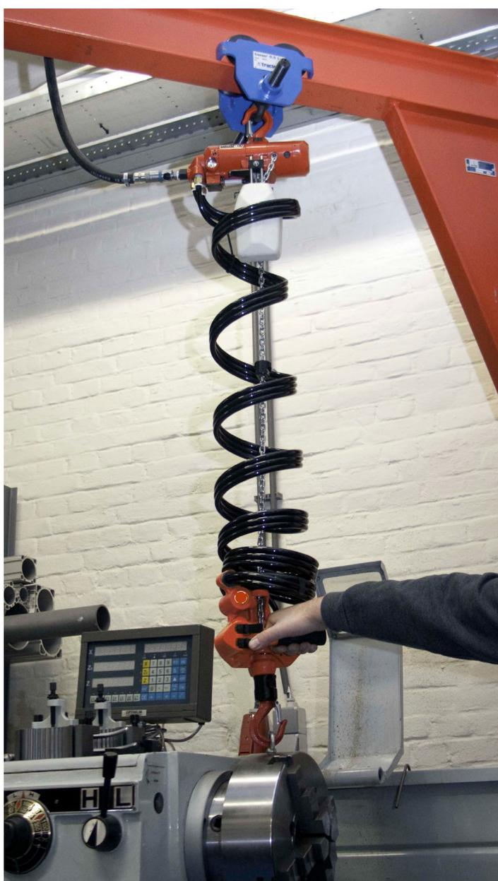
Il paranco Compatto RED ROOSTER è particolarmente idoneo per l' "asservimento macchine". Il comando a pulsantiera è direttamente collegato al gancio inferiore in modo che l'operatore possa facilmente controllare il carico. L'abbinamento con un carrello di traslazione a spinta garantisce il perfetto posizionamento anche in senso orizzontale.
